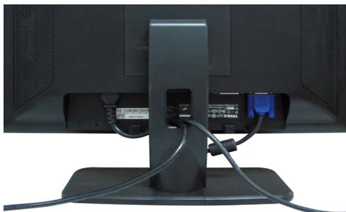
モニターおよびコンピュータに必要なケーブルすべてを取り付けた後、(ケーブルの取り付けについては、[モニターを接続する](#)を参照してください) 上記のとおり、ケーブル・ホルダを使って、すべてのケーブルを適切に調整します。
